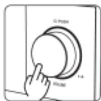
音量调节：屏幕在播放状态下，旋转旋钮为控制本机音量大小，适时针旋钮增加输出音量，逆时针旋钮减小输出音量
